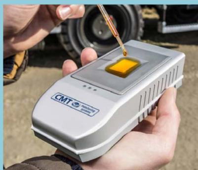
IR para oxidación, BN, TN, nitración, etc
