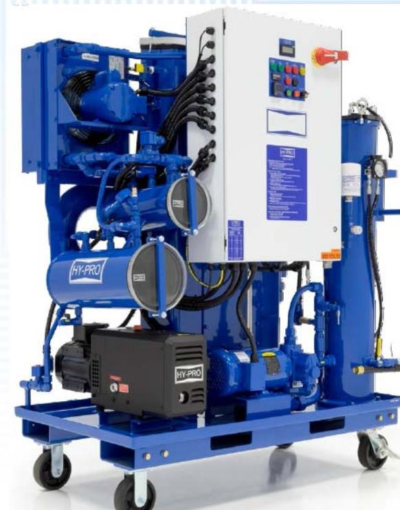
Equipos de vacío para eliminar agua en el aceite
